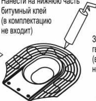
**4** Установить проходной элемент внахлест на мягкую черепицу на 20 мм
