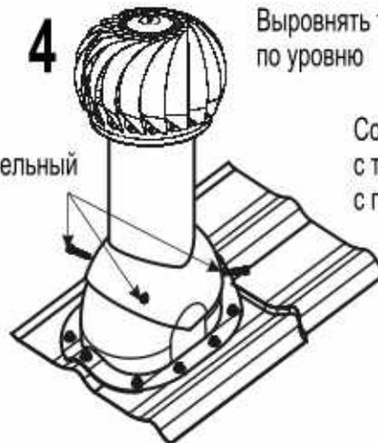
Соединяем гофру с трубой вентиляции с помощью хомута
