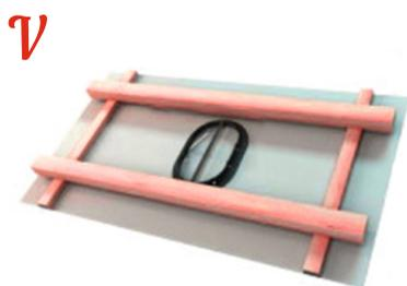
На гидроизоляционную пленку укладывается нижнее **кольцо А**, после следует обвести внутренний диаметр кольца
