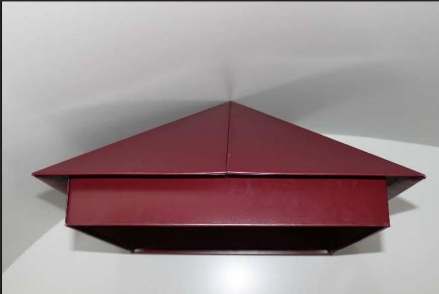
Колпак состоит из верхней водоотводящей части-крышки колпака и нижней части, закрывающей верхнюю кладку заборного столба, в которую производится крепление. Благодаря свесам верхней части колпака, выступающим на несколько сантиметров с каждой стороны и специально сконструированной юбке, влага стекает с колпака не на столб забора, а на отливы цоколя забора, выполняя роль зонта.
